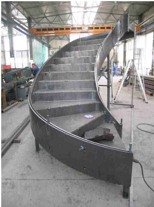
Rampa della scala elicoidale del Teatro Carignano di Torino durante un sopralluogo di verifica in officina
