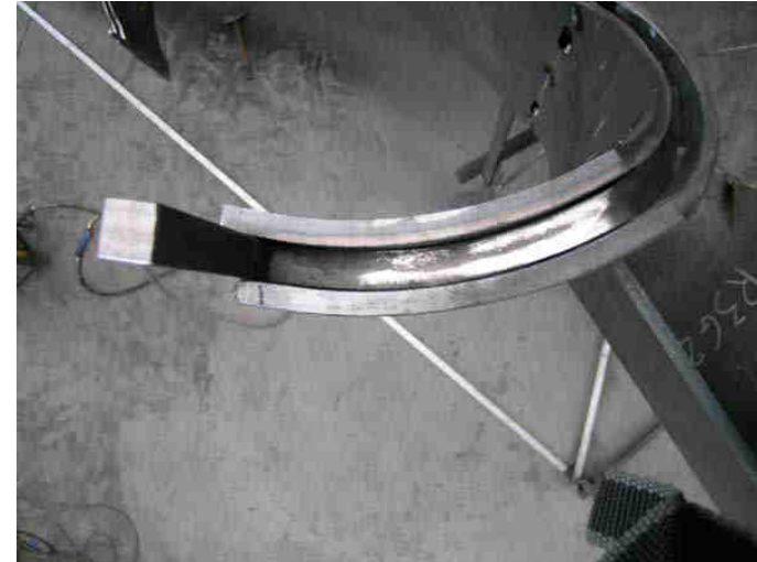
Rampa della scala elicoidale del Teatro Carignano di Torino particolare del doppio cosciale
